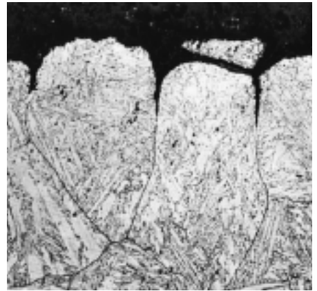
Schlechte Polierbarkeit aufgrund schlechter Oberflächengüte (Entkohlung) Poor polishability due to bad surface finish (decarburization)
